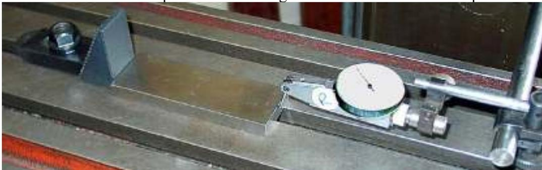
Figura 5.14 – Blocco calibro in posizione
