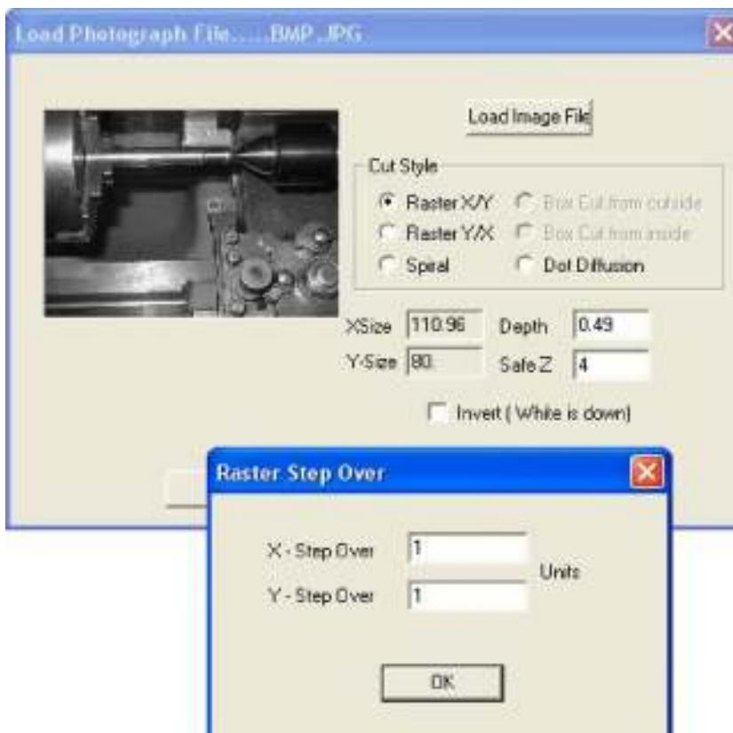
Figura 8.6 – Definizione dello Step over
