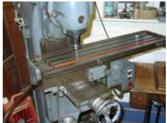
Figura 4.10 – Fresa con strumento in posizione X=0, Y=0 (si noti che il dente d’arresto è su un interruttore di limite)
