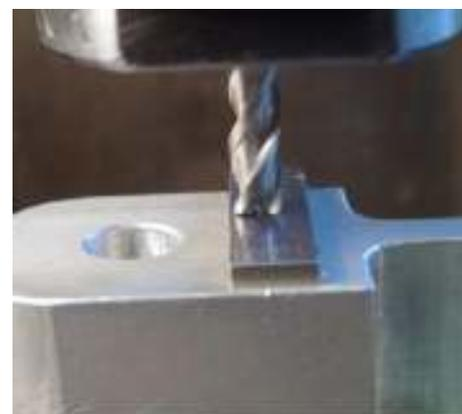
[Figura 7.6 – Estremità della fresa in un portastrumento programmabile](#)
