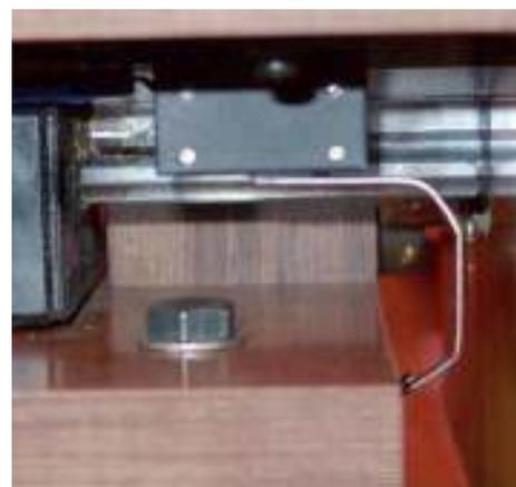
Figura 4.6 – Interruttore di limite – il microinterruttore montato sulla tavola viene movimentato dal bancale della macchina
