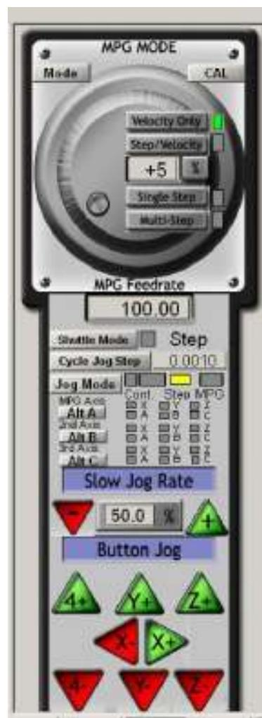
**Figura 3.4 – Controlli delle Movimentazioni ( utilizzare il tasto Tabulatore per mostrarlo e nascondarlo )**
