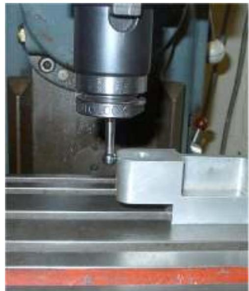
Figura 7.12 – Individuatore delle bordature in funzione in una fresa
