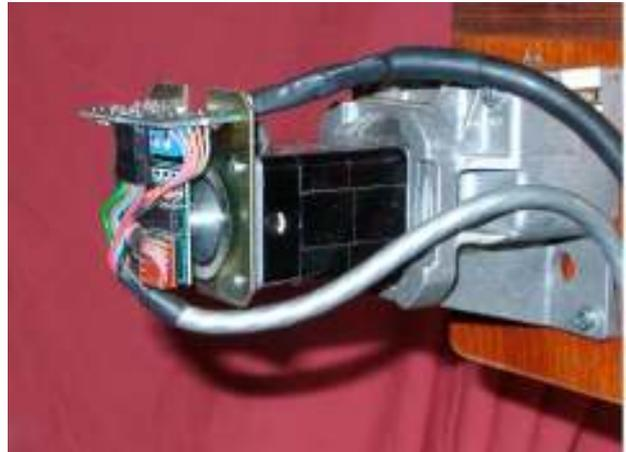
Figura 4.3 – Piccolo motore servo DC
